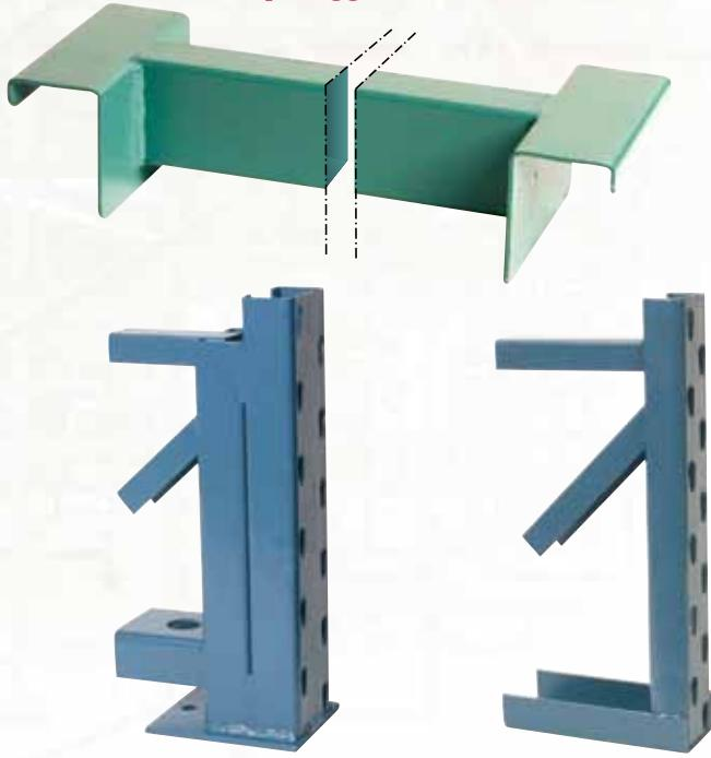
L'équerre en acier des lisses s'encastre sur les parties latérales de l'échelle, ce qui soulage les perforations et accroît la stabilité de la construction dans sa longueur. Grâce au positionnement ingénieux des perforations décalées d'Hovuma, les lisses se fixent – sous le poids croissant – de plus en plus précisément au montant. Un 'racordement fixe sans jeu' est ainsi créé, que rien ne fera bouger.
