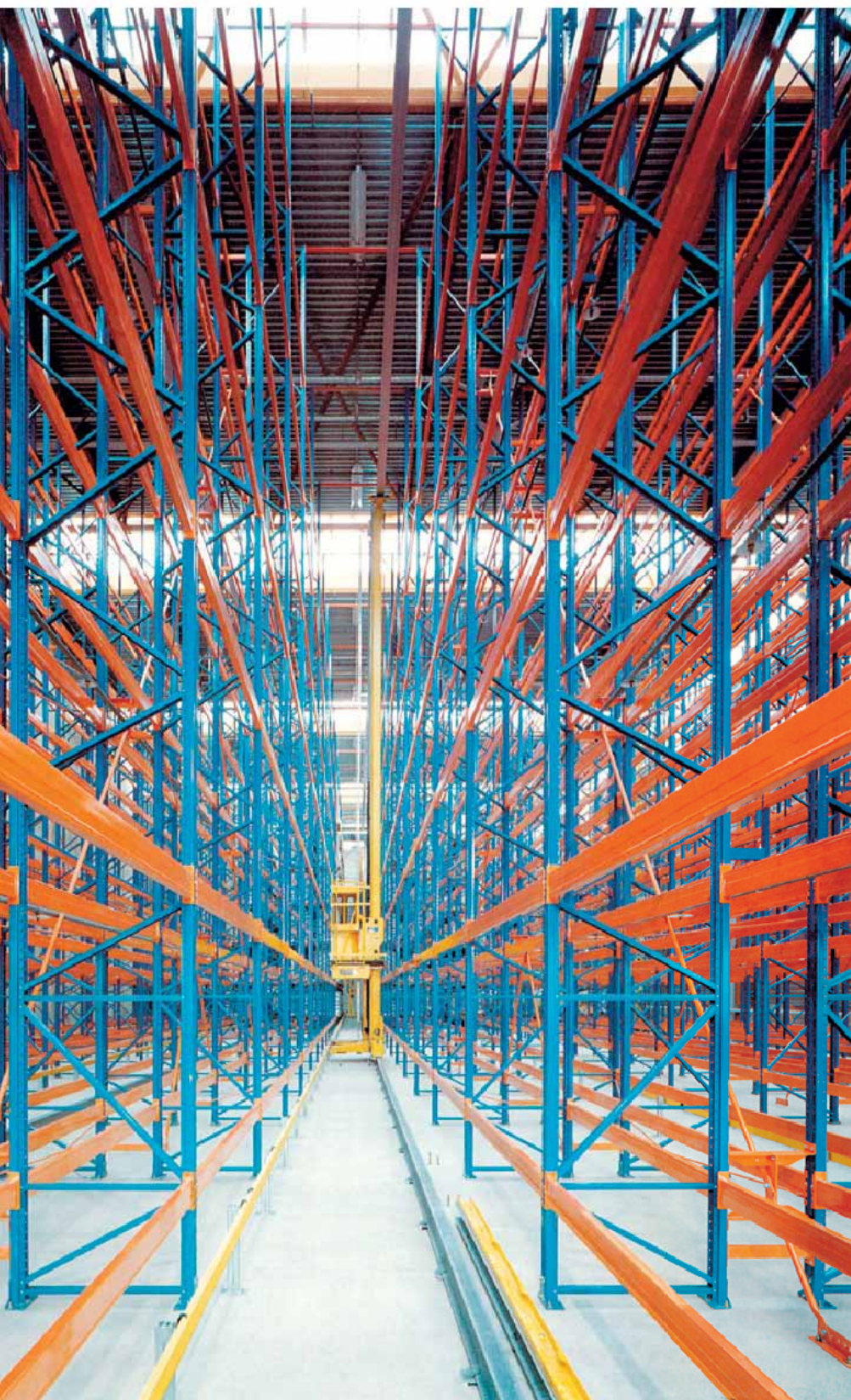
Een palletstelling in combinatie met stellingbedienings-hefkransen (SBH), uitgevoerd als dak- en wanddragend (als een silo), met hoogten tot ongeveer 45 m.
