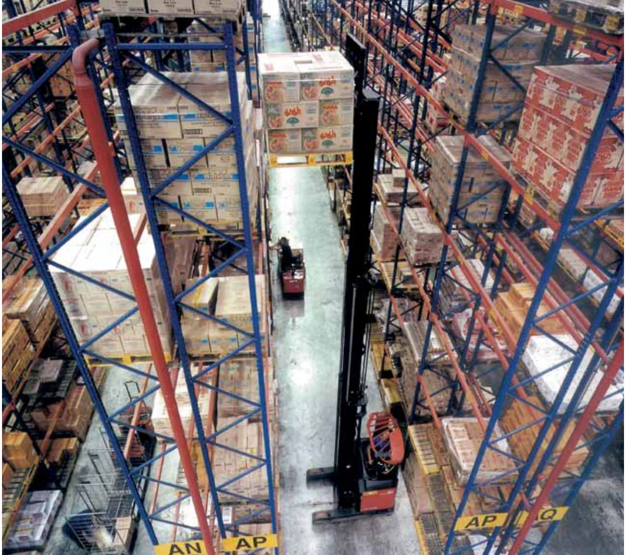
Palletstellingen, bediend door een 'hoogheffende' reach truck.
